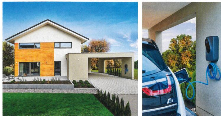
Eine Photovoltaikanlage erzeugt Strom für den Eigenverbrauch, ein Hausakku speichert ihn und das Elektroauto kann direkt im Carport „tanken“.
